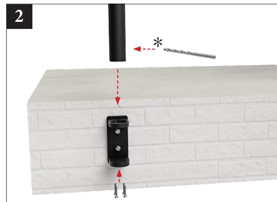
Før stolpen ned i stolpefestet. Skru fast de fire nederste skruene for å feste stolpen. \*Hvis stolpene monteres uten glass, må de dreneres ved å bore et 6 mm hull 10 mm fra nederkanten.
