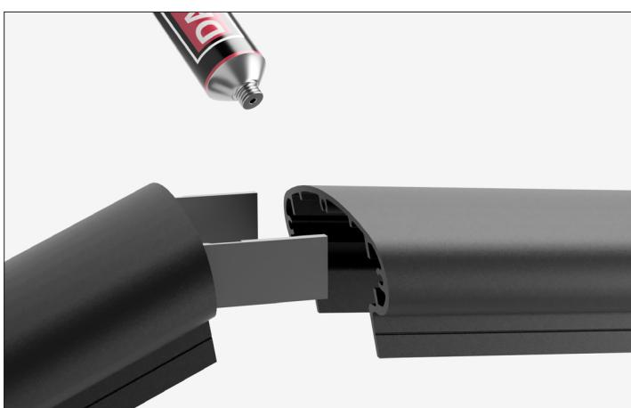
Hvis skjøter for trapp brukes, skal skjøtebeslagene limes fast. Bruk lim av typen Turbo Tack 291. Før beslaget inn til midten av senter. Trykk håndløperen inn fra den andre siden og press de to håndløperne sammen til riktig passform. Fest deretter håndløperen til stolpene.
