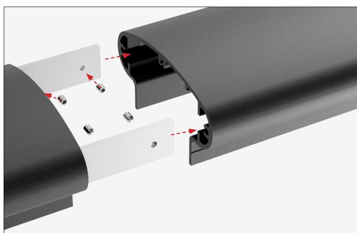
Hvis skjøter er nødvendig, skal skjøtebeslaget brukes. Trykk skjøtebeslaget på plass, og skru det fast i håndløperen på begge sider. Fjern grader fra spor og skjøtebeslag dersom det er vanskelig å føre skjøtebeslaget inn i håndløperen.
