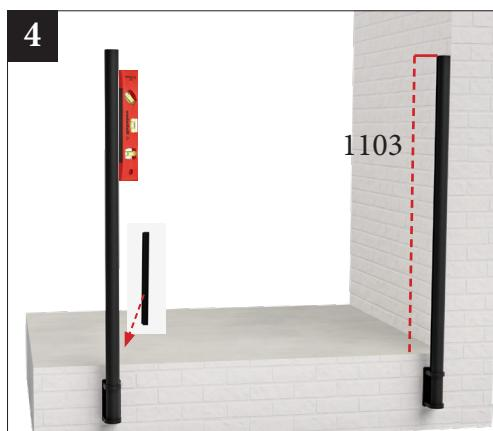
Kontroller at avstanden mellom gulv og toppen av stolpen er 1103 mm. Før den 178 mm dekkprofilen ned i glassporet. Stram fast stolpen med unbrakoskruen på siden av stolpefestet. Sjekk at stolpen står helt i lodd. Hvis stolpen heller fra eller mot underlaget, må det justeres ved å shimse mellom stolpefestet og underlaget.
