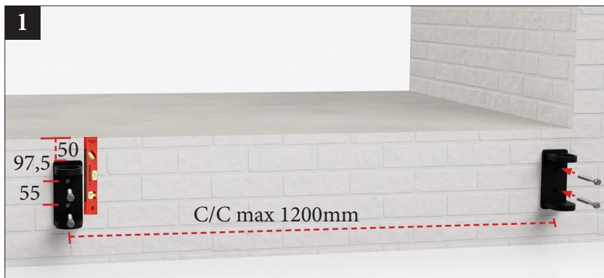
Start med å måle og markere hvor stolpene skal plasseres, og monter deretter stolpefestene i underlaget. Merk at c/c-avstanden mellom stolpene ikke må overstige 1200 mm.
